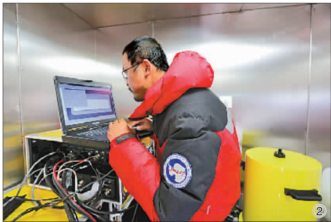
1月10日，中国第35次南极科考队昆仑队在南极昆仑站进行绝对重力测量，首次获得了南极内陆冰盖的高精度重力值。
