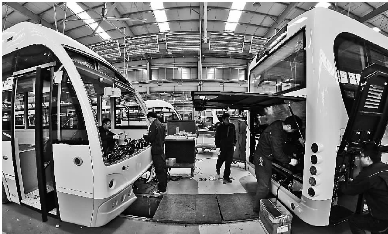
山东临沂轻量化电动客车生产忙 11月14日,工人在山东沂星电动汽车生产车间内为电动客车安装设备。近年来,该公司加大新能源汽车的研发力度,推出的具有轻量化车身技术的电动客车受到市场欢迎。 新华社发(唐克摄)
